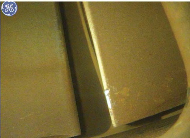
HPC STG11 Blade Nick on L/E Blade
